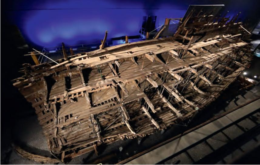
**Fig. 3** > Vue du flanc préservé de la Mary Rose, aujourd'hui exposé dans un musée spécialement construit à cet effet. Elle permet d'apprécier l'épaisseur des pièces de bois constituant la structure d'une coque construite à bordages, et permettant de supporter des pièces d'artillerie lourde (Geni, CC-share alike 4.0).
