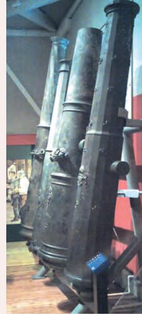
**Fig. 4** > Une partie de l'artillerie lourde de bronze de la Mary Rose. La troisième pièce a eu sa partie avant sciée, probablement en raison d'un éclatement de la gueule. Il est possible que cette modification, en réduisant les performances de la pièce mais aussi son encombrement, ait conduit à l'affecter à un usage naval.
